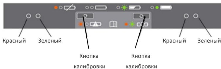
**Рисунок 3.5** Панель управления зарядного устройства с двумя отсеками
