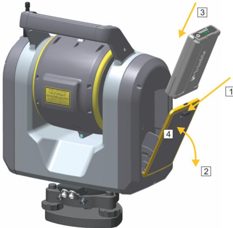
Рисунок 4.5 Как установить и/или извлечь внутренний аккумулятор
